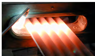
Spruzzatura e fusione su tubi di caldaie
